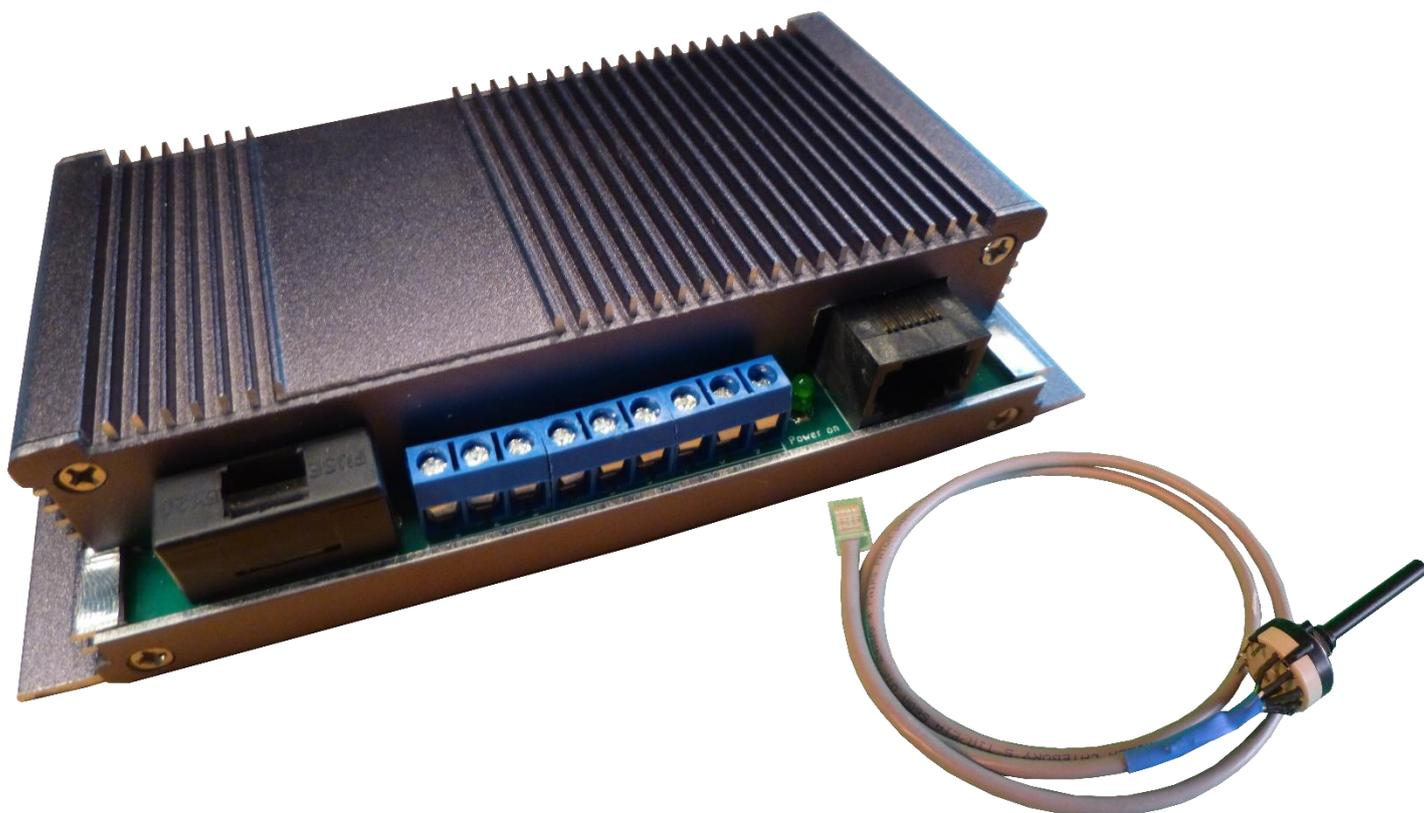
**Unser Scheibenwischer- Relais ist für den Anschluss, von allen 6V Scheibenwischermotoren an ein 12V Bordnetz entwickelt worden.**
